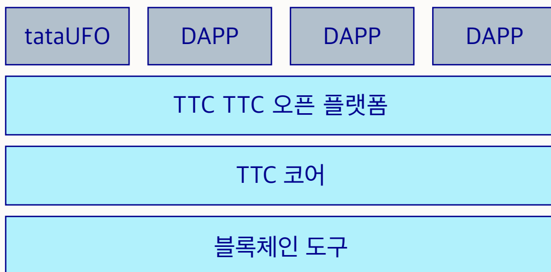
그림 9. TTC 시스템의 기술 아키텍처
